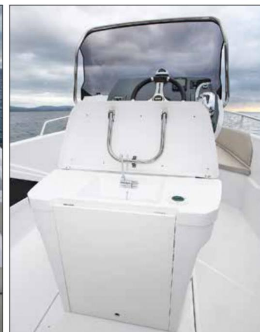
Ce leaning-post dissimule un évier sous l'assise et intègre une table relevable sur sa face arrière.
