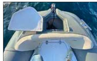
La baille à mouillage est profonde et assistée d'un davier et d'un taquet.
