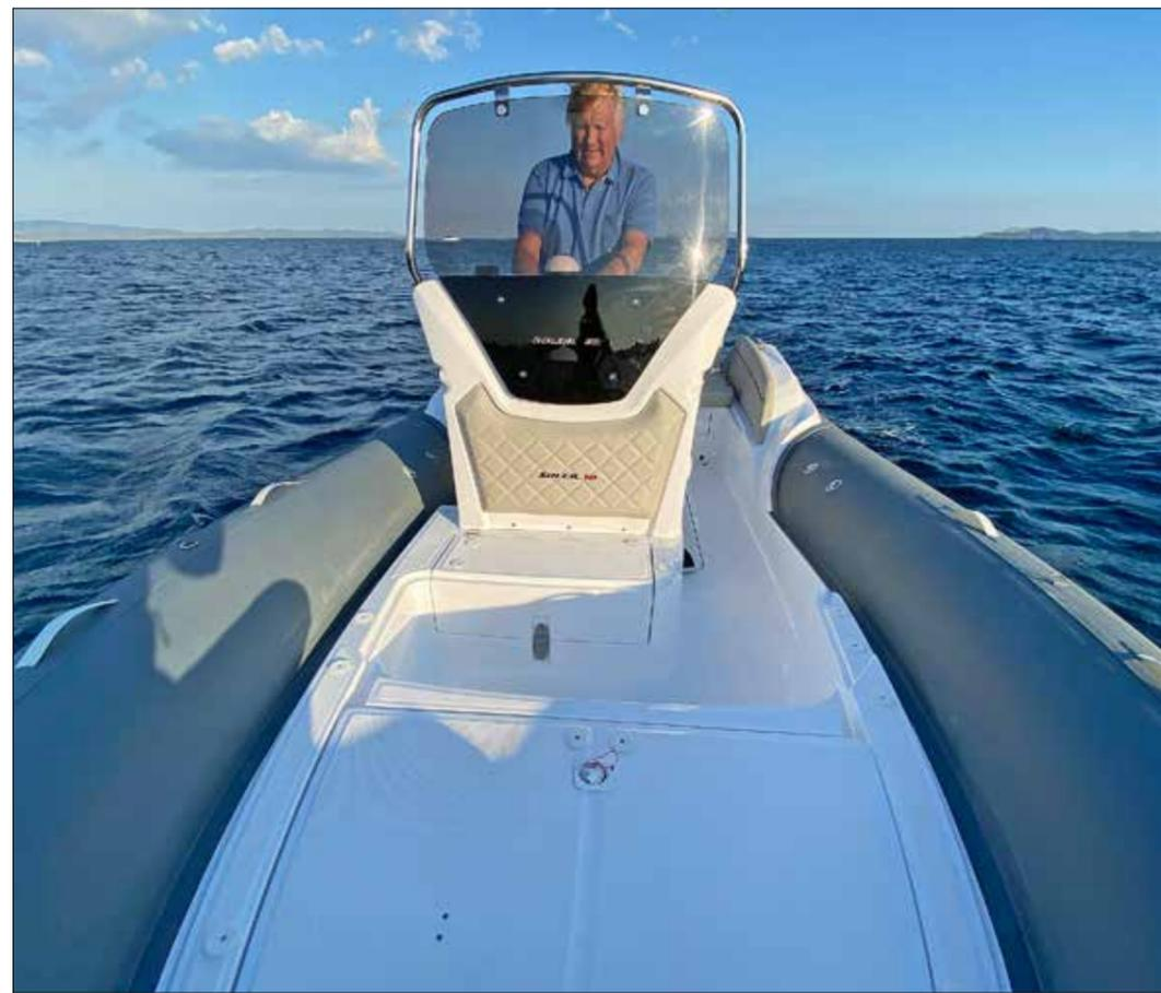
La console de pilotage est déportée sur tribord, laissant un passage entre l'avant et l'arrière sur bâbord.
