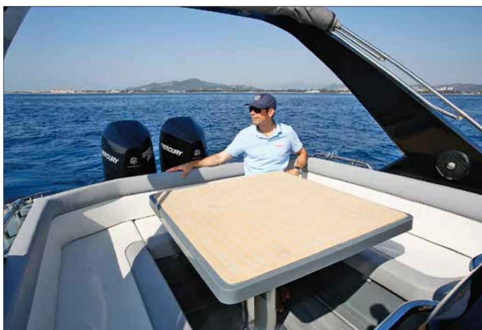
Dans le cockpit, la table, dissimulée dans le plancher, se soulève électriquement et peut accueillir au moins six personnes.
