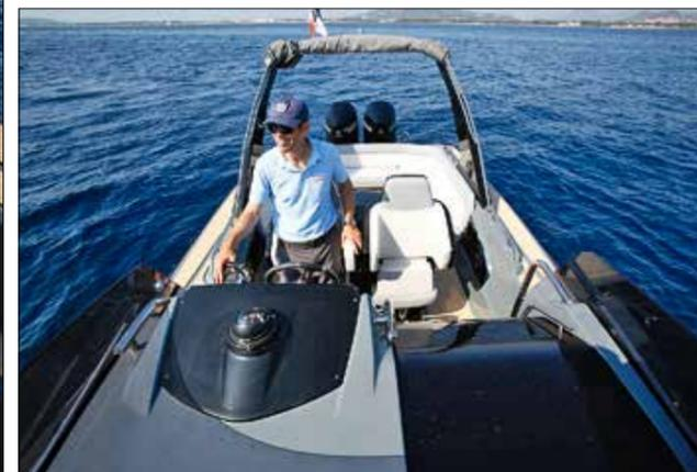
Pour un semi-rigide, le Salpa dispose d'un cockpit profond et bien protégé en raison du contre-moule de pont important qui remonte haut sur les flotteurs.
