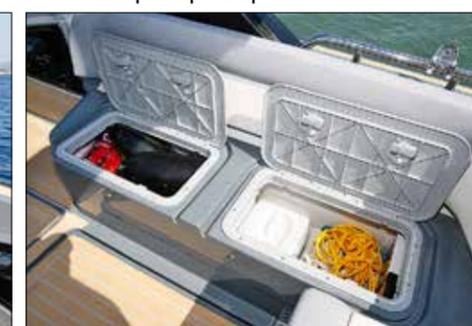
Sous les coussins de cockpit, les coffres bénéficient de fermetures étanches mais l'ouverture est un peu étroite.
